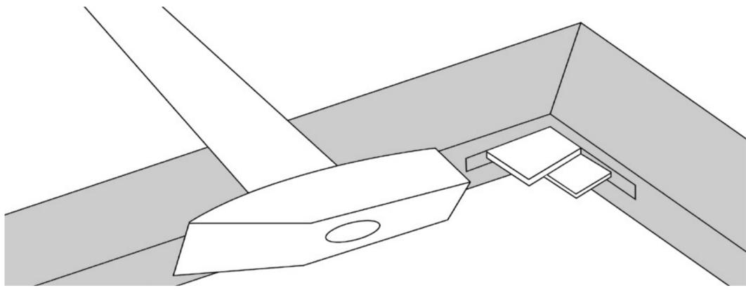
**1** Per tendere la tela battere leggermente i cunei di legno nelle fessure (scanalature) all'interno del telaio con un martello. Inserire nell'angolo prima il cuneo di legno inferiore e poi quello superiore. Procedere pian piano in maniera alternata, fino a raggiungere la tensione desiderata.
